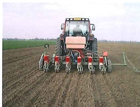
**Figure 4** : Semis de moutarde avec un semoir équipé d'un dispositif de désherbage sur le rang (herbissemis) permettant de diviser par deux la dose appliquée à l'hectare.
