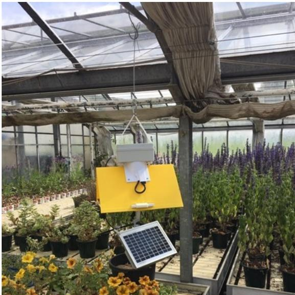
Le piège est alimenté par un panneau solaire (donc aucun branchement nécessaire).
