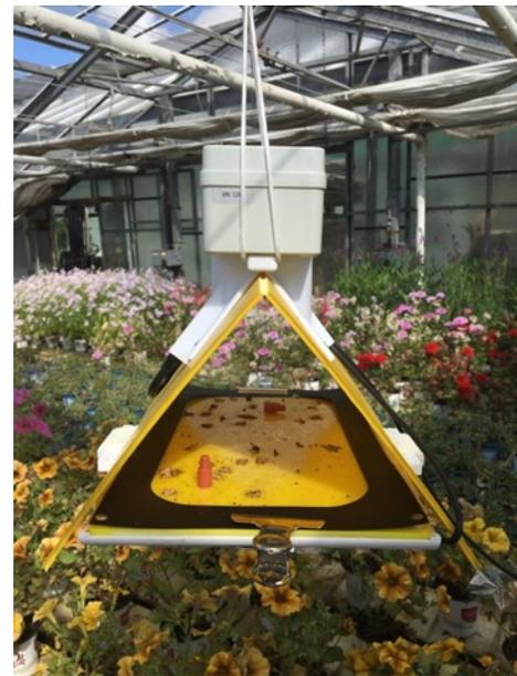
Equipé d'une carte sim, il transmet des photographies du piège à intervalle régulier et compte le nombre de ravageur cible collé (l'algorithme est basé sur la forme).
