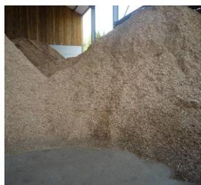
■ **La ventilation** : la bonne circulation de l'air favorise l'évacuation de l'humidité. Il faut pour cela éviter les stockages contre des murs bétons ou des bardages métalliques pleins. Le stockage contre des matériaux pleins risquant par ailleurs de créer une condensation au point de contact et des développements de moisissure.
