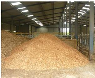
Pour les éleveurs qui produisent de la plaquette pour une autoconsommation en litière, il est possible de sécher et stocker les plaquettes dans les stabulations, une fois les animaux mis à la pâture. Réaliser dans ce cas le tas sur la largeur de la stabulation et non contre un mur pour favoriser la ventilation.
