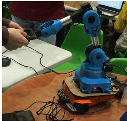
Figure 2: photographie du bras mécanique créée par l'UTBM pour démontrer la faisabilité d'un simulateur
