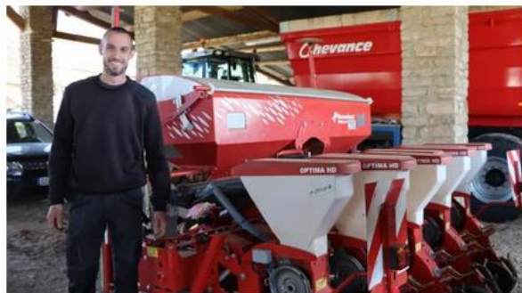
Mathieu Constantin a acheté ce semoir de précision pour implanter toutes ses cultures avec le même inter-rang de 50 cm.
